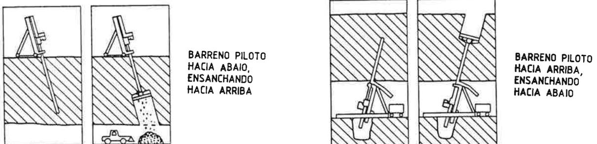
Figura 11. Principios del método escariador. El escariado puede hacerse desde la superficie o desde el túnel (hacia arriba o hacia abajo).
